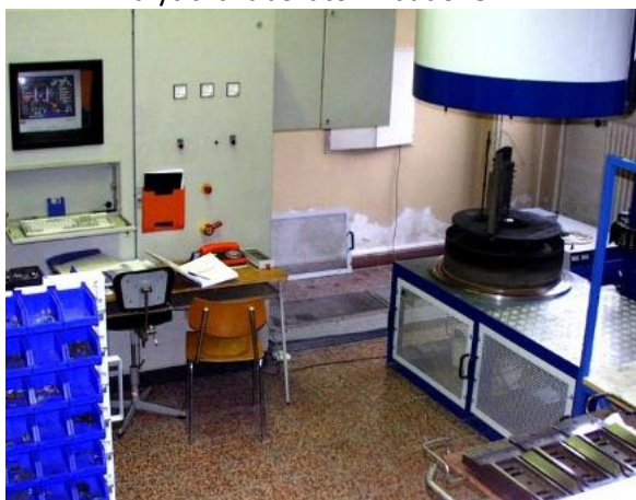
Tepelné zpracování – plazmová nitridace
